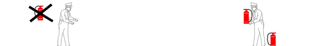
Una volta usato, l'estintore va sostituito con uno identico pieno.
