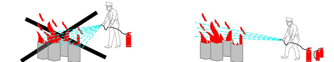
Olio e benzina accesi, situati in contenitori aperti, non vanno mai spenti usando l'estintore dall'alto, ma orientando il getto dell'estintore sul bordo del contenitore, cercando di rompere la fiamma per permettere il soffocamento dell'incendio.
